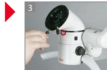
3 Затяните зажимной винт.
