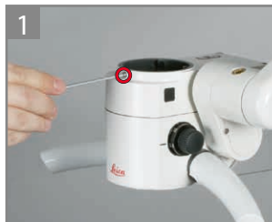
1 Выверните зажимной винт.
